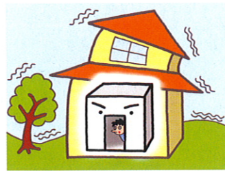
耐震シェルターの一例
